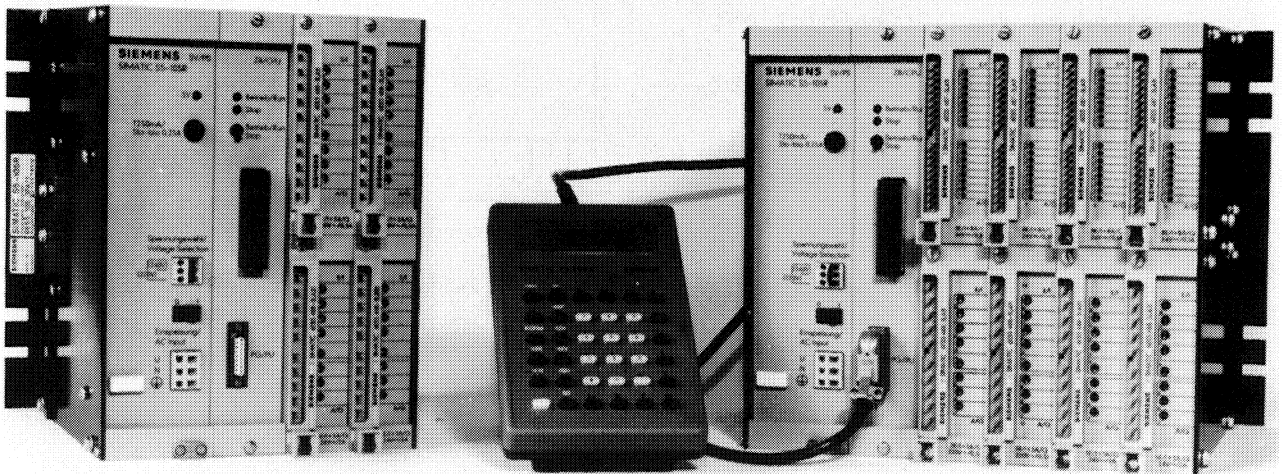
Bild 1 Automatisierungsgeräte S5-105R-A/-B mit Programmiergerät 605R
